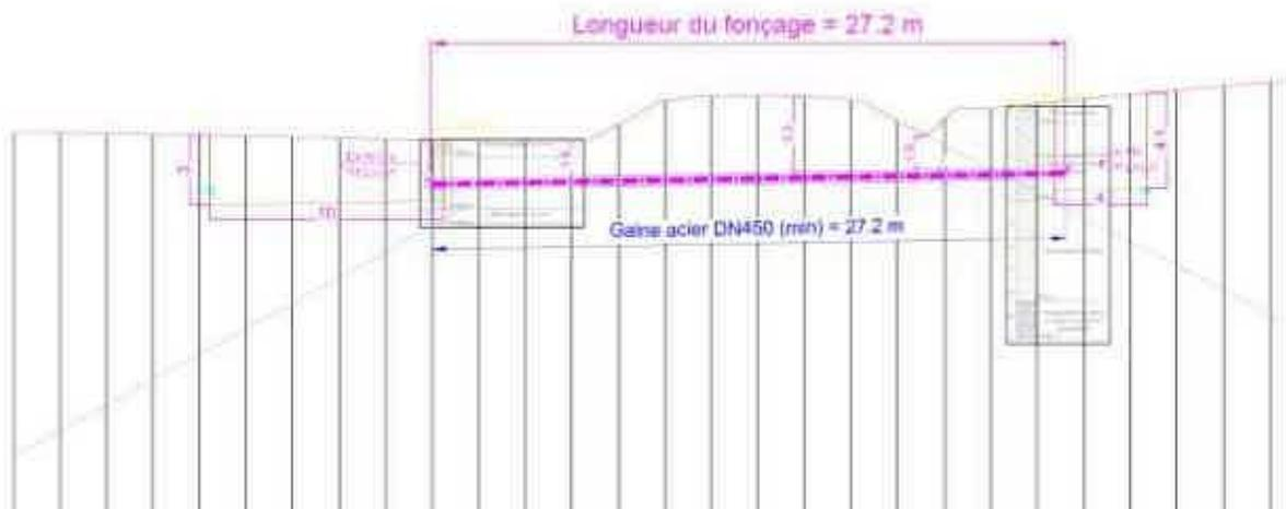
Figure 33 : Schéma du profil du Forage Droit
