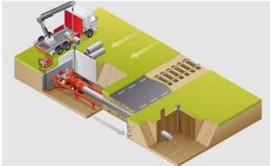
Figure 32 : Schéma de principe d'un Forage Droit
